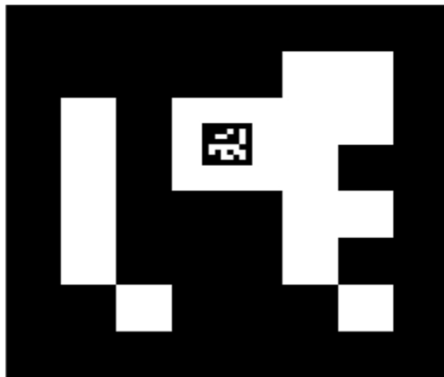
Рис. 2.7 – Модифікований маркер ArUco. Менший маркер ставиться у більший.
