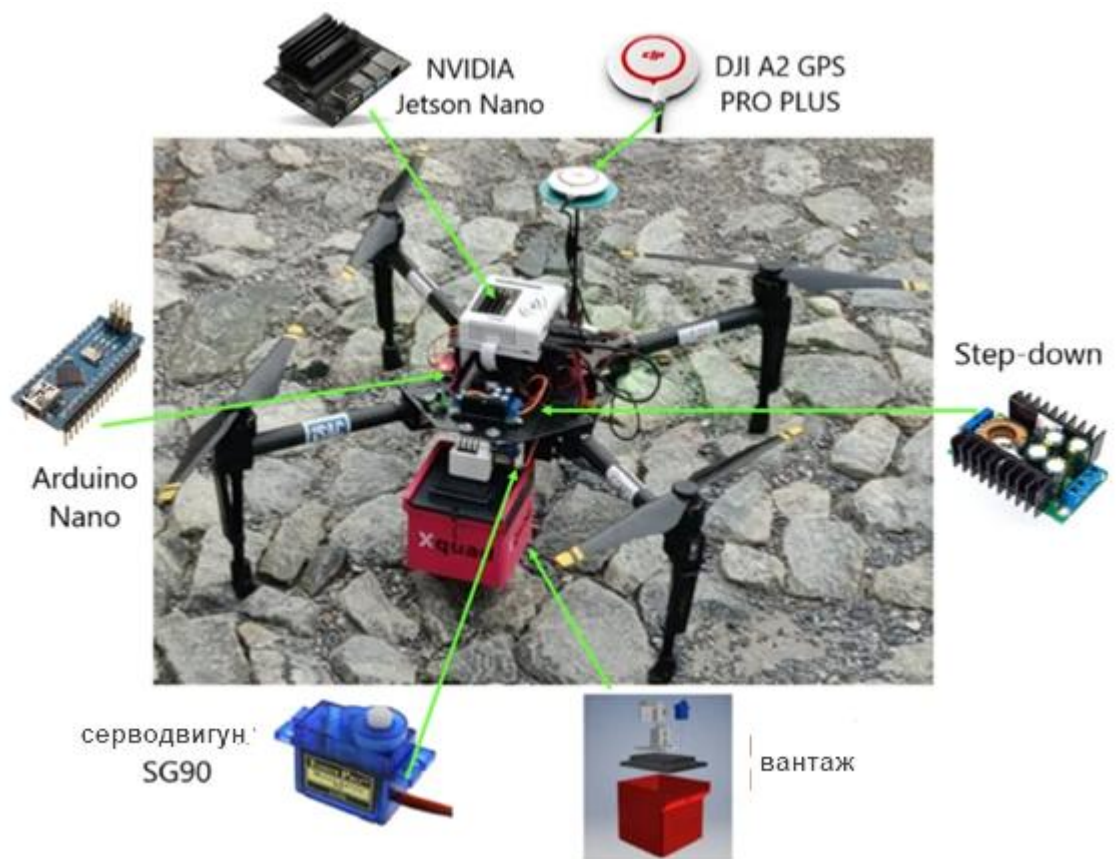
Рисунок 2.1 – Компоненти використовуваного БПЛА
