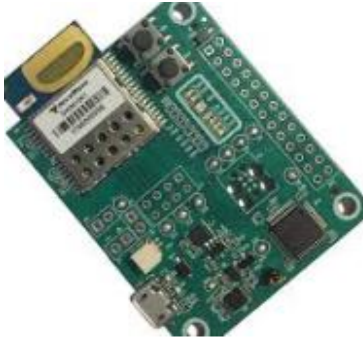
Рисунок 2.8 – Decawave DWM1001 Footnote 5 UWB
