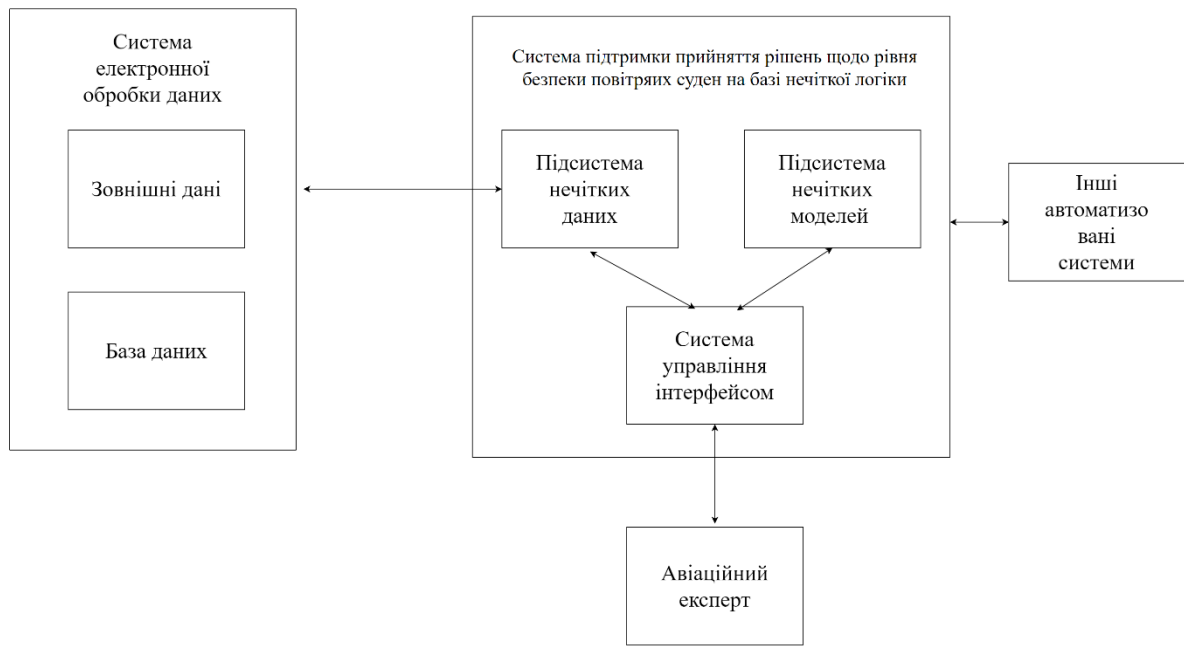
Рис. 2.2. Структурна схема роботи системи підтримки прийняття рішень
