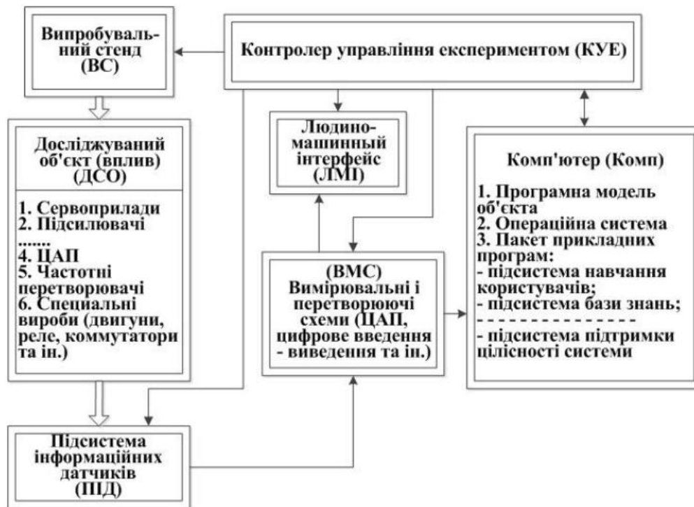
Рис. 24. Головні елементи системи напівнатурного моделювання
