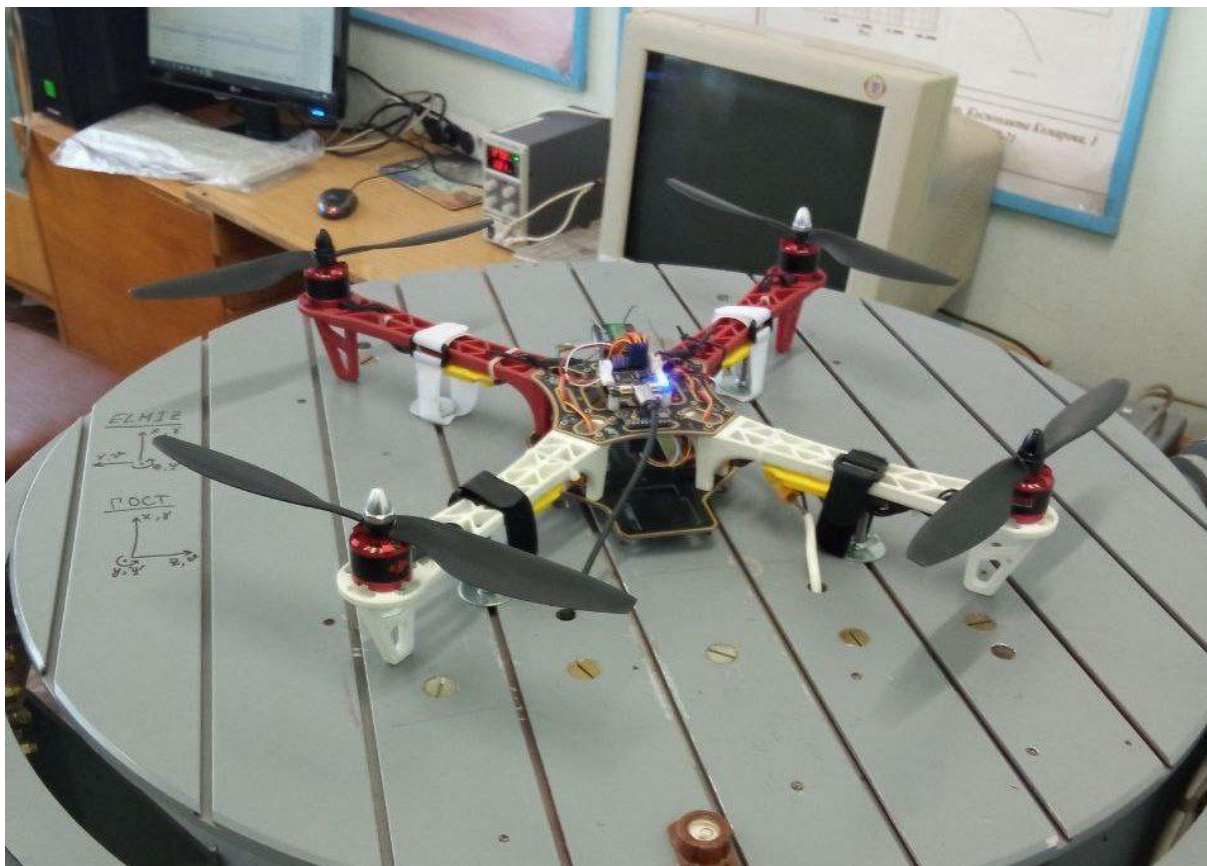
Рис. 23. Вигляд зібраного квадрокоптера для поканальної обробки сигналів крену
