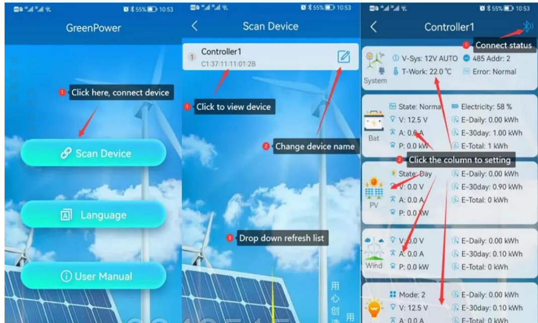
Рисунок 3.6. Екран мобільного додатку для керування контролером MPPT Wind 1000W/ Solar 1000W
