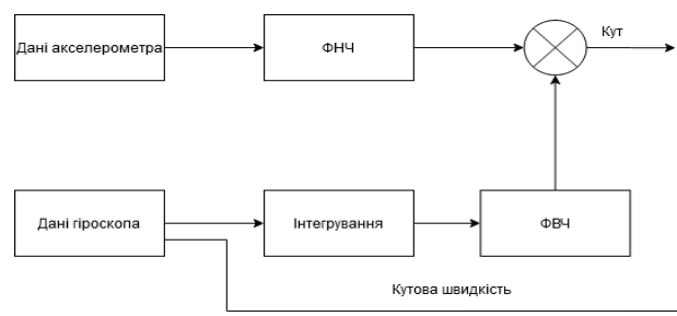
Рис.1. Структурна схема цифрового комплементарного фільтру для МЕМС гіроскопа і акселерометра
