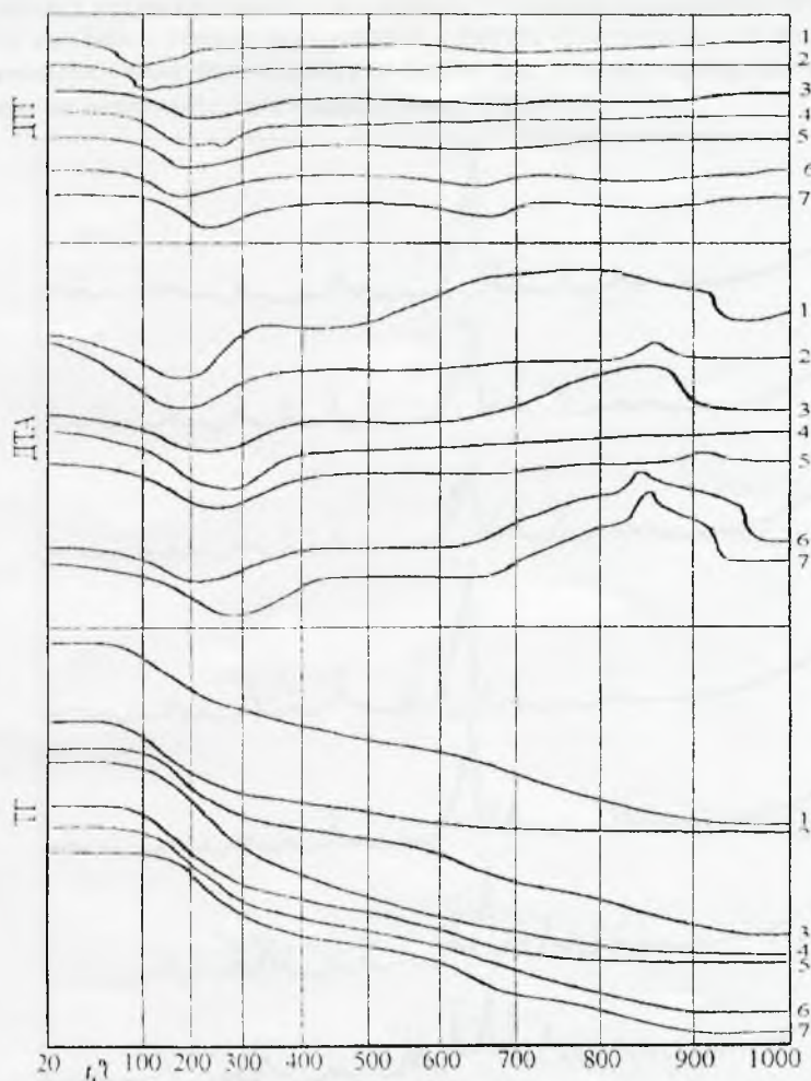
Рис. 2. Дериwатoгpаmи штучного каміню на основі оптимізованих складів в язучих (табл. 1) після 28 діб нормального тверднення.
