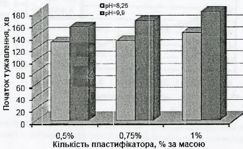
Рисунок 4 Вплив зміни кількості і величини \text{pH} пластифікуючої добавки на початок тужавлення лужних золівмісних цементів
