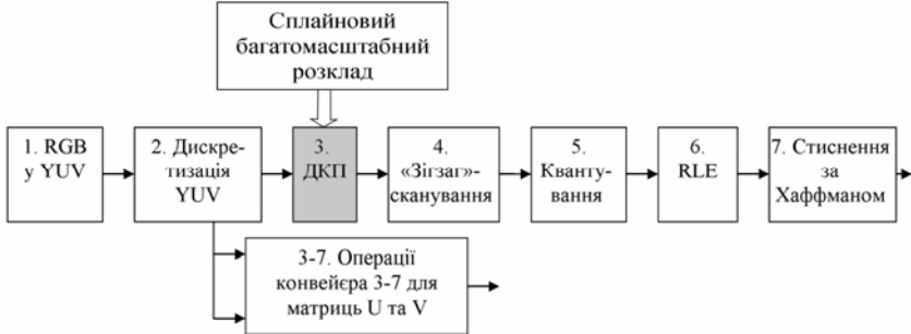
Рис. 2. Конвеєр операцій, який використовується в алгоритмі JPEG
