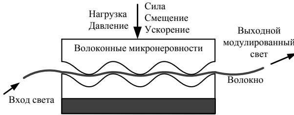
Рис. 7.35. Волоконнооптический датчик неровностей
