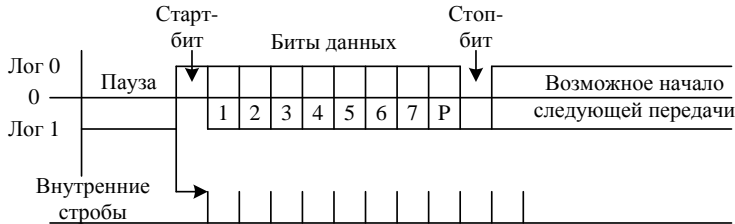
Рис. 10.11. Формат асинхронной передачи
