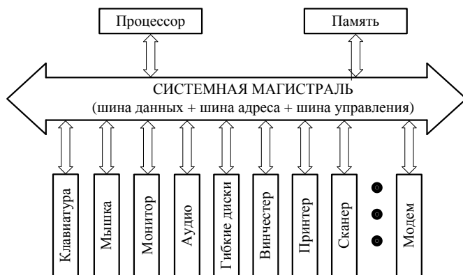
Рис. 10.2. Структура КС, реализующая магистрально-модульный принцип
