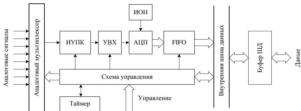
Рис. 9.25. Структурная схема системы сбора данных
