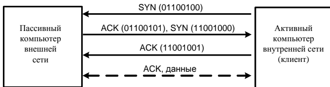
Рис. 14.37. Схема квитирования связи по протоколу TCP
